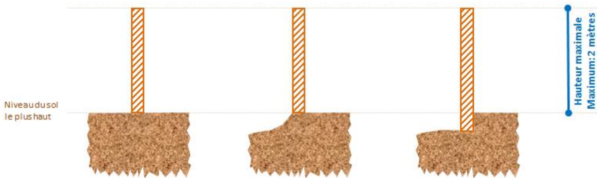
Schémas explicatifs de la hauteur maximale des clôtures dans le secteur 1AUx
