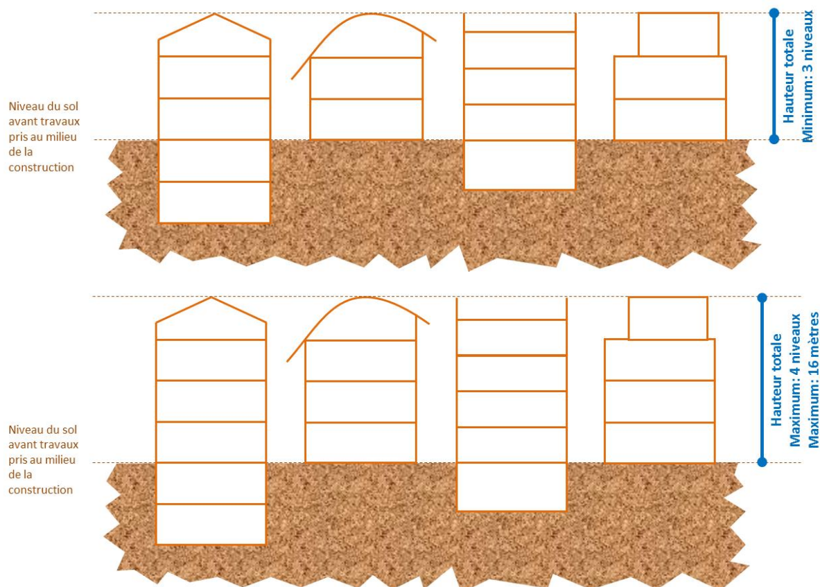
Schémas explicatifs des hauteurs minimale et maximale des constructions dans le sous-secteur Uasr
